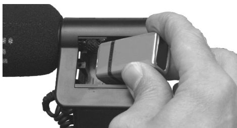
Figura 3 - Inserir a bateria
