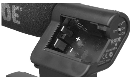
Figura 2 - O compartimento da bateria
